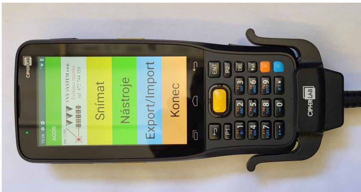
Datový terminál CipherLab RK-25 s programem VVV-System pro Ginis
